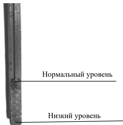
Рисунок 6 – Проверка уровня масла в корпусе редуктора
