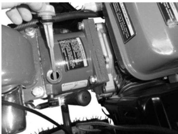
Рисунок 6 – Проверка уровня масла в корпусе редуктора
