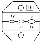
Опрессовка наконечников, разъемов и гильз с термоусаживаемой изоляцией и концевых изолирующих заглушек КИЗ
