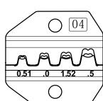
Опрессовка неизолированных разъемов и наконечников (авто-климм) под двойной обжим по жиле и изоляции
