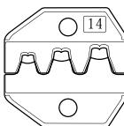
Опрессовка неизолированных разъемов и наконечников (авто-клещм) под двойной обжим по жиле и изоляции
