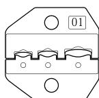
Опрессовка изолированных наконечников и гильз с красной, синей и желтой манжетами
