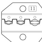
Опрессовка изолированных разъемов с красной, синей и желтой манжетами
