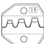
Опрессовка неизолированных разъемов и наконечников (авто-клещи) под двойной обжим по жиле и изоляции
