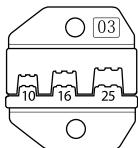
Опрессовка одинарных изолированных и неизолированных втулочных наконечников
