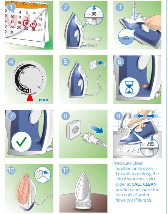
**DE** Verwenden Sie die Calc-Clean-Funktion jeden Monat, um die Lebensdauer Ihres Bügeleisens zu verlängern. Halten Sie den Schieberegler auf der Position "CALC CLEAN", und schütteln Sie das Bügeleisen solange, bis das ganze Wasser herausgelaufen ist (Abbildung 9).
