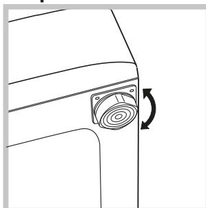
устойчивое положение путем вращения передних ножек (см. рис.). Для этого сначала ослабьте контргайку, после завершения регулировки контргайку затяните.
