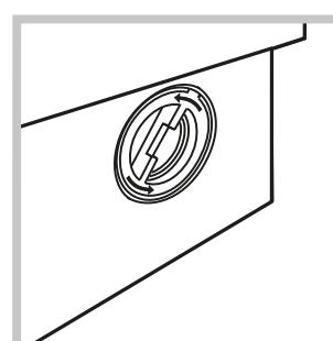
2. отвинтите крышку, повернув ее против часовой стрелки (см. схему): небольшая утечка воды является нормальным явлением;
