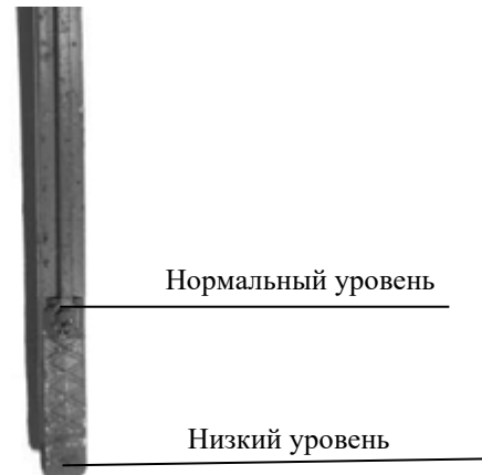
Рисунок 6 – Проверка уровня масла в корпусе редуктора
