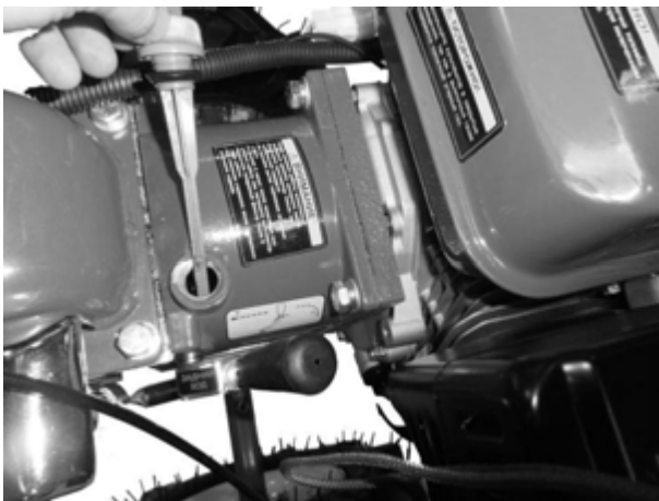
Рисунок 6 – Проверка уровня масла в корпусе редуктора
