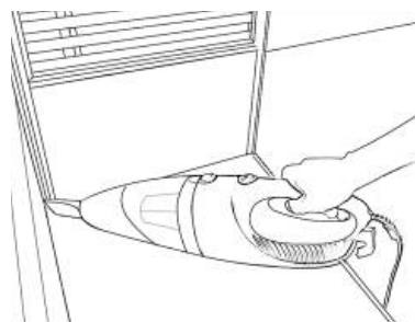
При использовании данной насадки - рекомендуется снять с прибора удлиняющую трубку. Держась за ручку прибора (а не за ручку удлиняющей трубки) Вам будет легче направлять насадку в труднодоступные места.
