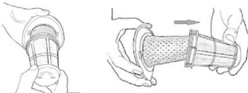
Вымойте фильтр и защитную сетку чистой теплой водой, затем полностью высушите их. Установите на фильтр защитную сетку и зафиксируйте ее, повернув сетку по часовой стрелке. После этого установите фильтр в пылесборник.
