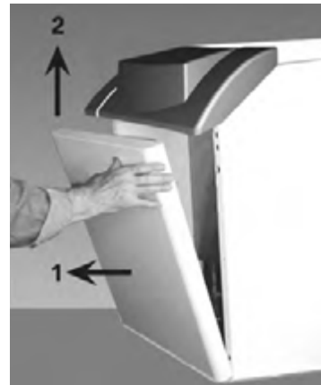
рис. 18 - Открытие передней панели
