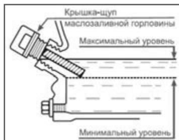
Рис. 8 Проверка уровня масла в картере
