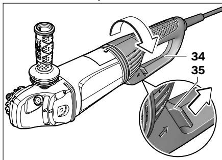
دسته اصلی 34 در محور بدنه موتور تا 90° درجه به سمت چپ و یا راست قابل چرخش است. به این ترتیب میتوان کلید روشن/خاموش را برای مواد ویژه کار در وضعیت مناسب برای بکار بردن و دسترسی به آن قرار داد. از جمله برای برش کاری و جداسازی با سریوش مکنده و راهنمای برش 18 و برای استفاده افراد چپ دست مناسب است.
