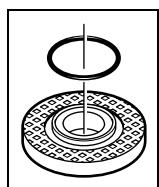
Un joint en plastique (rondelle élastique) est directement monté autour de l'alésage du flasque **5**. **Au cas où cette rondelle élastique fasse défaut ou qu'elle soit endommagée**, il faut absolument remplacer la flasque d'entraînement **5** avant de continuer à l'utiliser l'outil.
