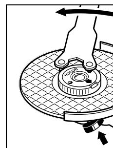
Un écrou de serrage rapide non endommagé qui a été correctement fixé peut être desserré à la main en tournant l'anneau moleté dans le sens inverse des aiguilles d'une montre.
