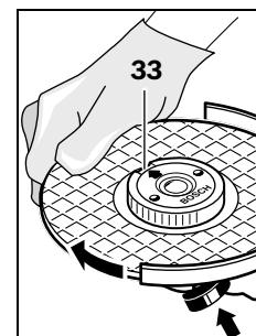
Натисніть на фіксатор шпинделя **1**, щоб зупинити шліфувальний шпиндель. Для затягнення швидкозатисконої гайки з силою поверніть шліфувальний круг за стрілкою годинника.
