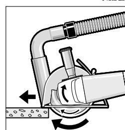
شغل العدة الكهربائية وأسندتها بالجسم الأمامي من زلاقة التوجيه على قطعة العدة الكهربائية إلى الأمام بدفع معتدل وملائم للمادة المرغوب لمعالجتها.
