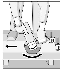
هنگام برش بروفلیل ها و لوله های چهارضلعی، بهتر است از کوچکترین ضلوع مقطع برش شروع بکار کنید.
