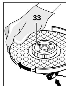
Afin de bloquer la broche d' entraînement, appuyez sur le dispositif de blocage de la broche 1. Afin de serrer l'écrou de serrage rapide, tournez fortement la meule dans le sens des aiguilles d'une montre.
