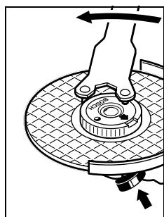
Закріплену належним чином, непошкоджену швидкозатиску гайку можна відпустити, вручну повертуючи кільце з накаткою проти стрілки годинника.
