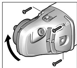
Головку редуктора можна повертати з інтервалом у 90°. Завдяки цьому вимикач буде знаходитися у більш зручному для певних видів роботи положенні, напр., при розрізанні з витяжним ковпаком з лунетним супортом **18** або якщо Ви лівша.
