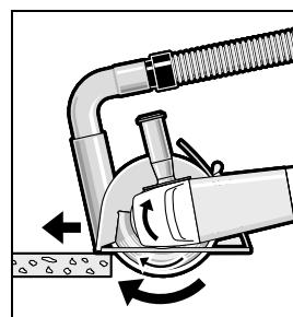
Elektrikli el aletini çalıştırın ve kılavuz kızığının ön kısmını iş parçası üzerine yerleştirin. Elektrikli el aletini makul ve işlenen malzemeye uygun bir bastırma kuvveti ile hareket ettirin.
