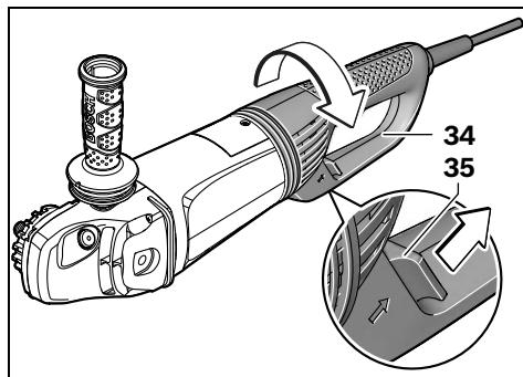
Головну рукоятку **34** можна повертати відповідно до корпуса мотора на 90° ліворуч або праворуч. Завдяки цьому вимикач буде знаходитися у більш зручному для певних видів роботи положенні, напр., при роботі з витяжним ковпаком з направляючою шиною **18** або якщо Ви лівша.
