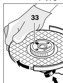
یک مهار سریع (مهار SDS) بدون نقص که به درست مکم شده است، را میتوانید بواسیله دست از طریق چرخش حلقه شبیدار آن، در خلاف چهت حرکت عقربه ساعت باز کنید.
