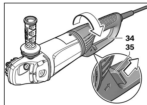
Главную рукоятку **34** можно повернуть на 90° налево или направо. Таким образом выключатель может быть установлен в более удобное для работы положение, например, для отрезных работ с кожухом для отсасывания и направляющими салазками **18** или для левши.
