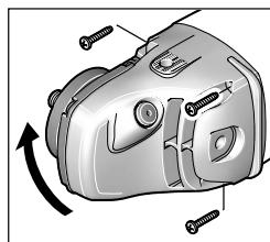
تنت استفاده از قاب محافظ مجهر به سریوش مکنده با راهنمای برش (مخصوص برش سنگ) 18 و همچنین برای استفاده افراد چپ دست.
