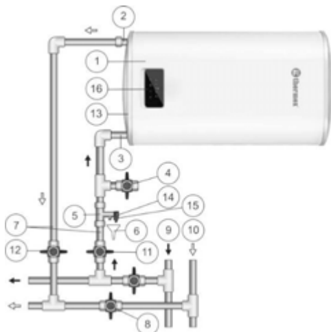
Рисунок 2. Схема подключения ЭВН к водопроводу в горизонтальном положении
