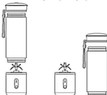
Нажмите последовательно два раза на кнопку включения и переверните блендер. Не включайте уже перевернутый блендер, так как может возникнуть перегрузка. Для более равномерного смешивания можно встряхнуть продукты в блендере. В некоторых случаях надо постоянно встряхивать продукты, как в шейкере, для лучшего приготовления.
