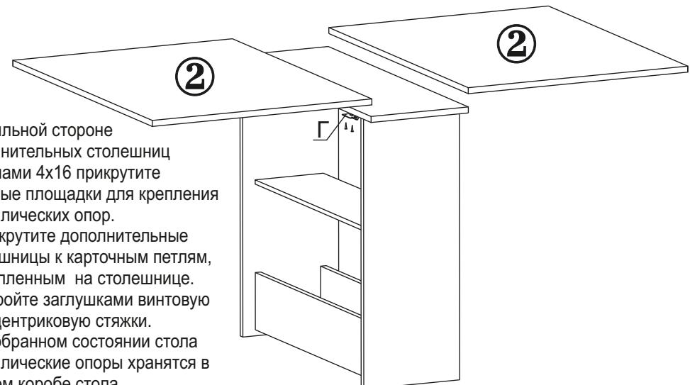
1.3. К тыльной стороне дополнительных столешниц шурупами 4x16 прикрутите опорные площадки для крепления металлических опор.
