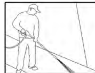
Рис. 6. Оптимальный угол относительно очищаемой поверхности
