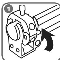
**Положить инструмент на ровную поверхность. Выбрать необходимый зажим COAC . Повернуть зажим врачающийся так чтобы штифт расположился между зазором стойки.**
