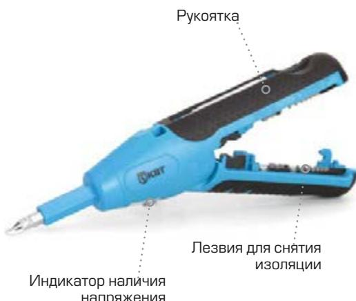
Ручной стриппер WS-05 состоит из двухкомпонентной, раскрывающейся рукоятки, мини-гопозиционных лезвий для резки и разделки кабеля/проводка, наконечника для установки отверточных бит и индикатора наличия напряжения в сети
