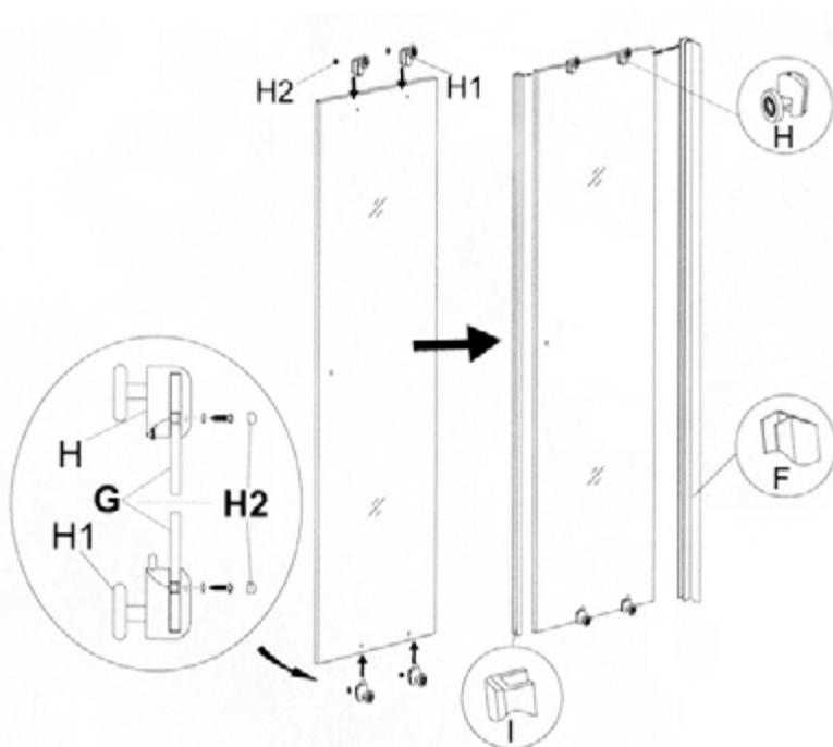
После сборки изделия загерметизируйте места соединения профиля со стенкой и ванной нейтральным санитарным силиконом.
