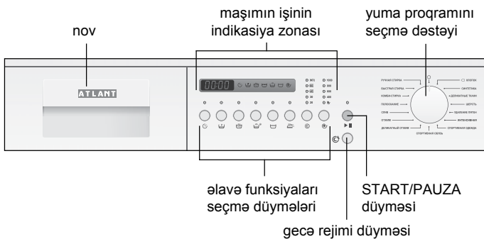
Şəkil 1 – İdarəetmə paneli
