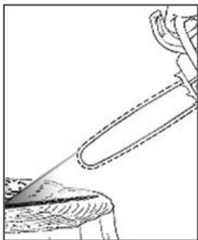
Рис. 9 Проверка смазки шины и цепи
