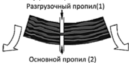
Рис. 13 Распиливание дерева, когда его нижняя часть находится под напряжением
