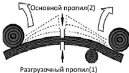
Рис. 15 Распиливание дерева, когда оба конца дерева зажаты и находятся под напряжением
