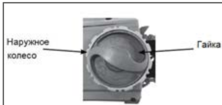
Рис. 2 Конструкция гайки крепления крышки шины
