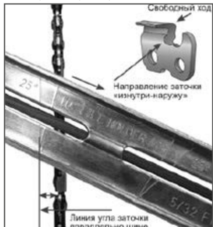
Рис. 18 Определение угла заточки
