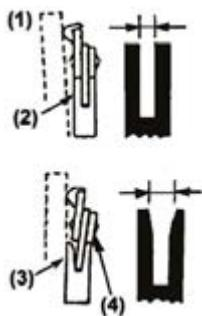
Направляющая шина должна всегда быть прямоугольной. Проверяйте шину на наличие износа. Проверяйте шину и внешнюю сторону зуба линейкой(1) см.рис. 14. Если между ними есть зазор (2), направляющая нормальна. В ином случае (3) она изношена. Такую шину нужно корректировать или заменять.
