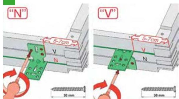
8. Монтаж оконной рамы. Нижний край рамы выставляется по уровню и крепко прижимается монтажными уголками к обрешетке. Верх рамы должен оставаться подвижным для повторной регулировки.
