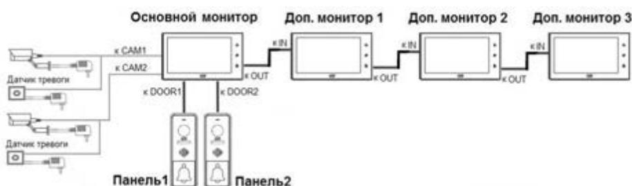
Вызывные панели подключаются только к основному монитору.
