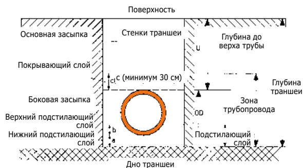
Рис. 3 Устройство траншеи
