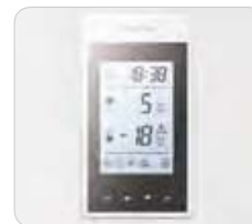
Дисплей с сенсорными кнопками электронного блока управления
