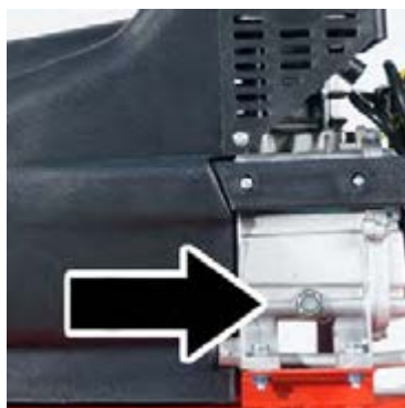
Модель WIND. Сливной болт по середине правой части картера, размер 17.
