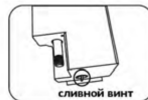
Выкрутите сливной винт
