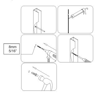
Вставьте собранную душевую дверь в настенный профиль. Выровняйте её строго вертикально и просверлите отверстия сквозь настенный профиль. Закрепите все при помощи шурупов.
