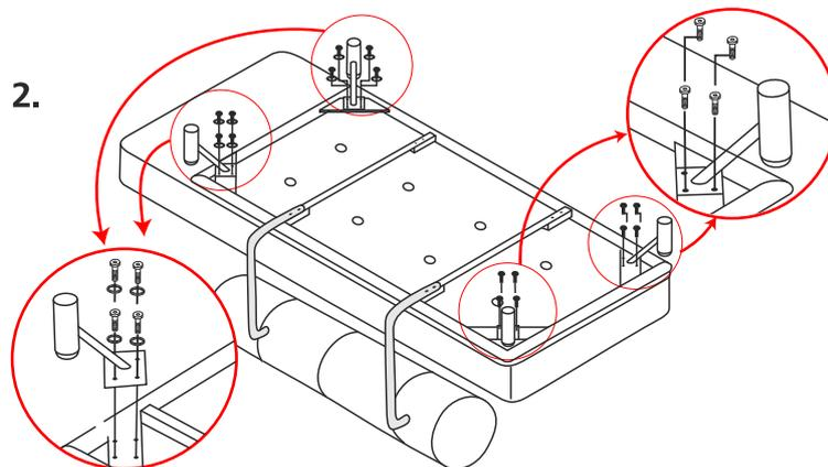
Закрепить ножки болтами 8x20, ввернув их непосредственно в раму. Со стороны спинки закрепить ножки болтами 8x20 и гроверами (гроверы использовать только в серых каркасах).
