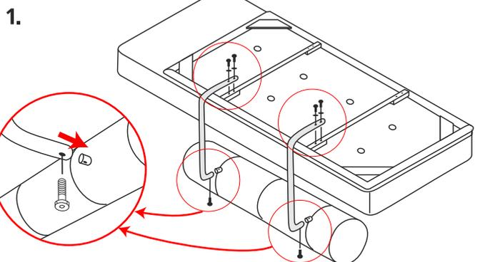
Закрепить кронштейны к валику болтами 6x30. Закрепить кронштейны шайбами и болтами 8x50, ввернув их в раму.
