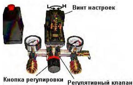
Ограничение давления было установлено при изготовлении. Не меняйте его. Как только двигатель отключается, сжатый воздух в выпускной трубе нужно спустить с помощью выпускного клапана под переключателем. Это необходимое условие для перезапуска, при несоблюдении этого условия двигатель будет поврежден. Установленное давление можно регулировать с помощью вращения винта настроек (см. Рис.).
