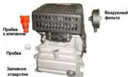
Если спусковой клапан не работает, когда двигатель выключен, немедленно определите причину, чтобы не повредить двигатель.
