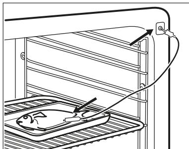
Вставьте наконечник Термощуп точно в центр запеканки. Во время запекания Термощуп не должен менять своего положения в блюде. Для этого зафиксируйте его при помощи одного из более твердых ингредиентов. Для фиксации силиконовой ручки Термощуп воспользуйтесь краем посуды, в которой производится запекание. Наконечник Термощуп не должен касаться днища посуды для запекания. Выложите поверх Термощуп другие ингредиенты.
