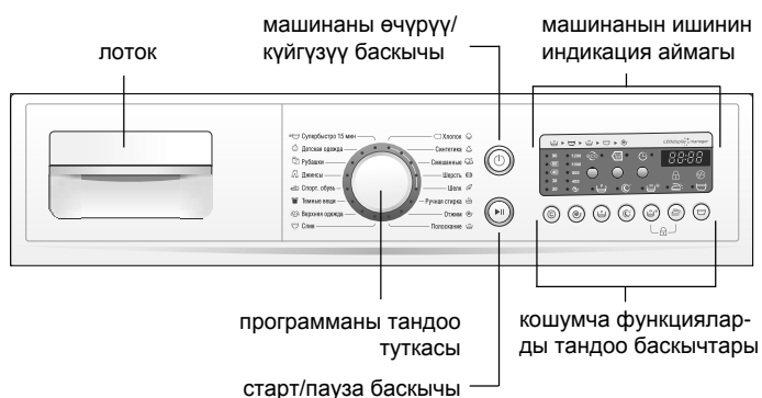
1-сүрөт — Башкаруу панели
